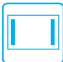
Diese Leuchte enthält eingebaute LED-Lampen.
